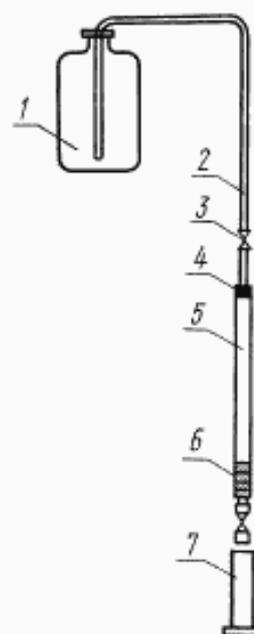
1 — бутылка вместимостью 10—20 дм<sup>3</sup>; 2 — сифон; 3 — зажим; 4 — пробка; 5 — цилиндрическая стеклянная трубка (диаметр — 16,5±0,5 мм; h ≥ 850 мм); 6 — фильтр (пористая стеклянная пластинка); 7 — цилиндр
